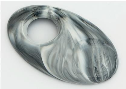
**Bild 2.** Auch dreidimensionale Artikel können mit Marmorierungseffekten spritzgegossen werden. Bei der Herstellung kommt es auf die richtige Dosierung und Kombination von „Kontrast“-Batches und farbgebender Komponente an © BASF
