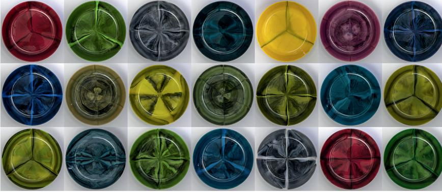
**Bild 1.** Abhängig von der verwendeten Kanalgeometrie lassen sich sehr unterschiedliche Marmorierungen erzeugen © BASF
