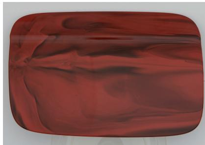
**Bild 3.** Durch Werkzeuge mit Heißkanälen und Tunnelangüssen können ebenfalls sehr attraktive Muster hergestellt werden. Da diese Formteile nicht zentral angespritzt sind, zeigen die Marmorierungsschlieren einen anderen Verlauf © BASF
