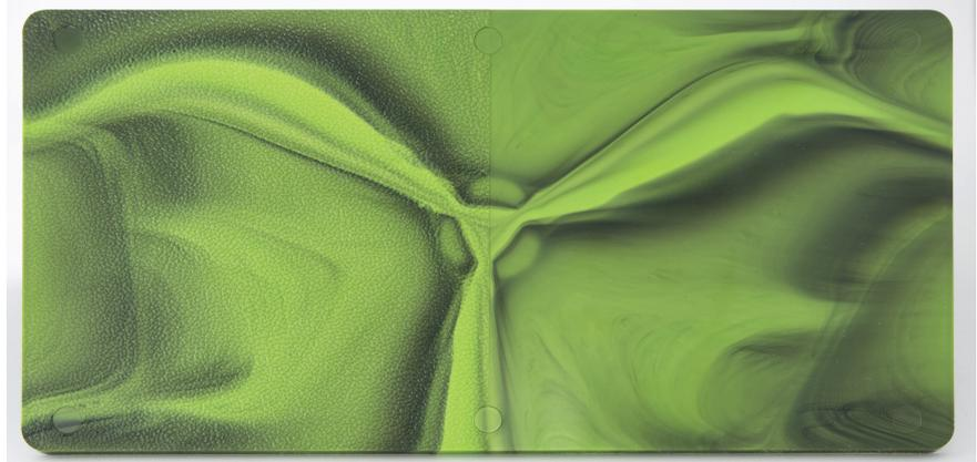
**Bild 5.** Die Oberflächenqualität der Werkzeugkavität beeinflusst das Erscheinungsbild der Muster. Hochglanzpolierte Oberflächen bringen die Kontraste stark zur Geltung. Strukturierte Oberflächen sorgen für ein mattes Erscheinungsbild © BASF
